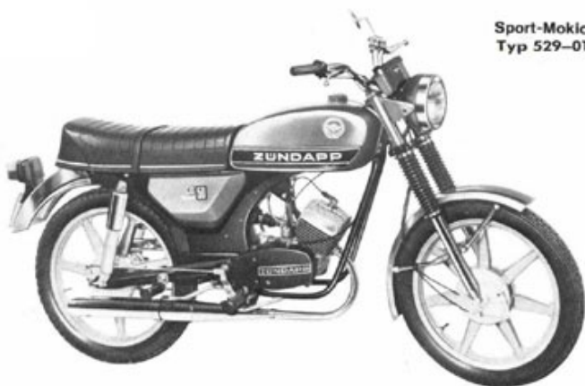
C 50 Sport mit fahrtwindgekühltem Motor, 2,1 kW (2,9 PS), 3 Gänge, Fuß- schaltung, Kickstarter, Super-Einzel-Cockpit mit Tachometer
