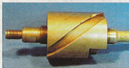
Beschädigte Führungsnut des Ziehkeils auf der Schaltlocke mit Druckmarken bzw. Ausbrüchen.
