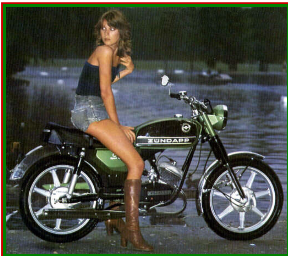
C 50 Sport mit fahrtwindgekühltem Motor, 2,1 kW (2,9 PS), 3 Gänge, Fuß- schaltung, Kickstarter, Super-Einzel-Cockpit mit Tachometer
