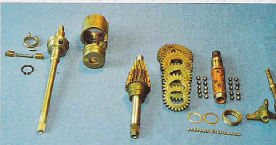
▲ Die Einzelteile des Getriebes.
