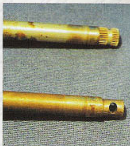
Verzahnung der Schaltwelle: Neuteil und ein verschlissenes, unsachgemäß repariertes Exemplar.
