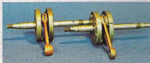
▲ Pleuelwellen mit obengeführtem Pleuel (li.) bzw. untergeführtem Pleuel.
