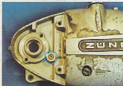
Die Bolzenaufnahme im rechten Seitendeckel darf keine Risse aufweisen.
