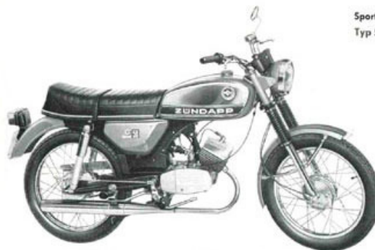
C 50 Sport mit fahrtwindgekühltem Motor, 2,13 kW (2,9 PS), 3 Gänge, Fußschaltung, Kickstarter, Super-Einzel-Cockpit mit Tachometer
